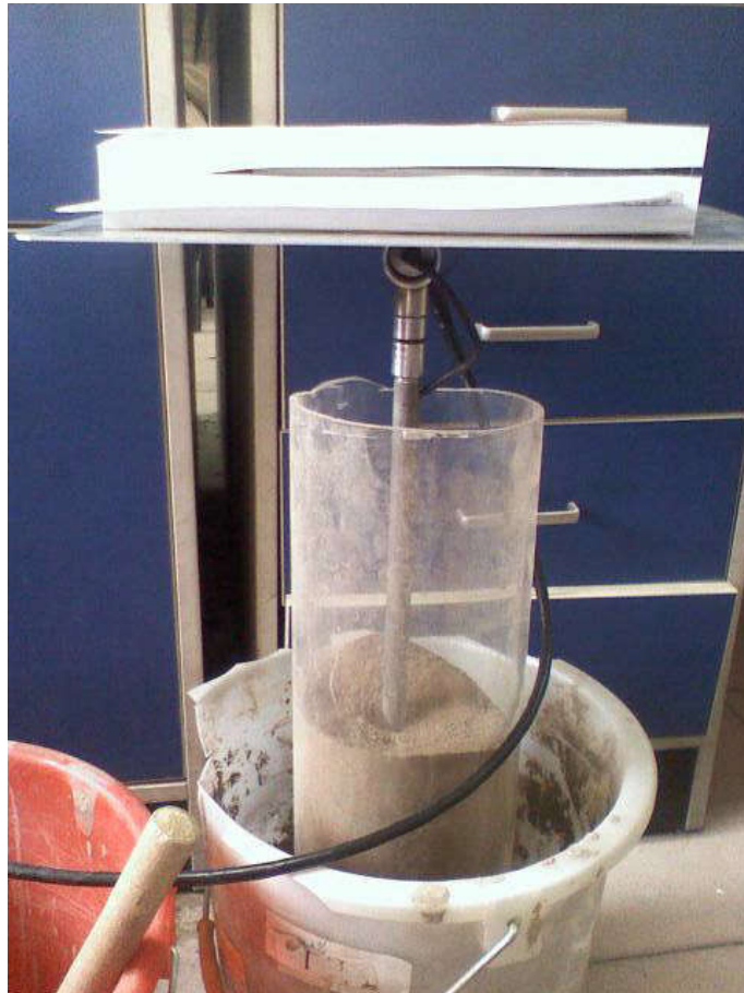
图 4-5 土壤紧实度传感器输出电压实验实物图
